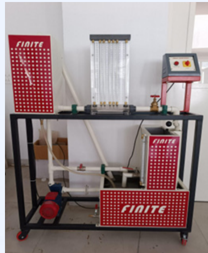
उपकरण का नाम-04: बर्नौली का प्रमेय विशेषज्ञता: जल संसाधन इंजीनियरिंग प्रयोगशाला लैब का नाम: हाइड्रोलिक्स लैब
